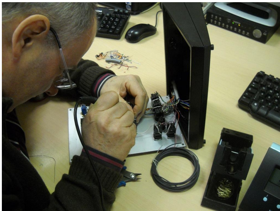
Fig. 13: Fasi di ricablaggio della pulsantiera in control room
