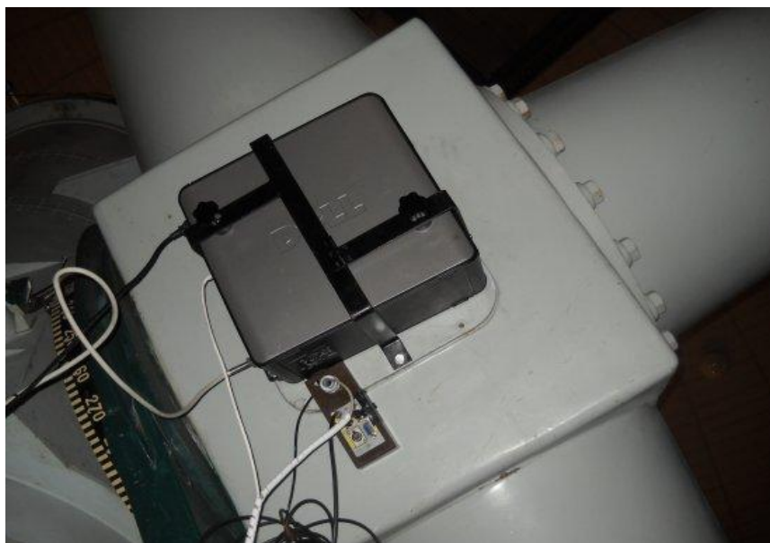
Fig. 8: Il cubo di intersezione degli assi. Sotto al pc DELL si trova un coperchio che deve essere rimosso per raggiungere l'encoder.
