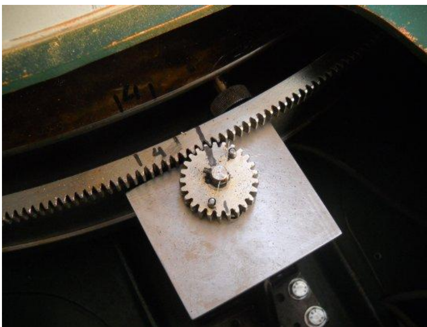
Fig. 7: Il vano sotto al carter che contiene l'encoder. L'encoder e' posizionato sotto alla lastra metallica.
